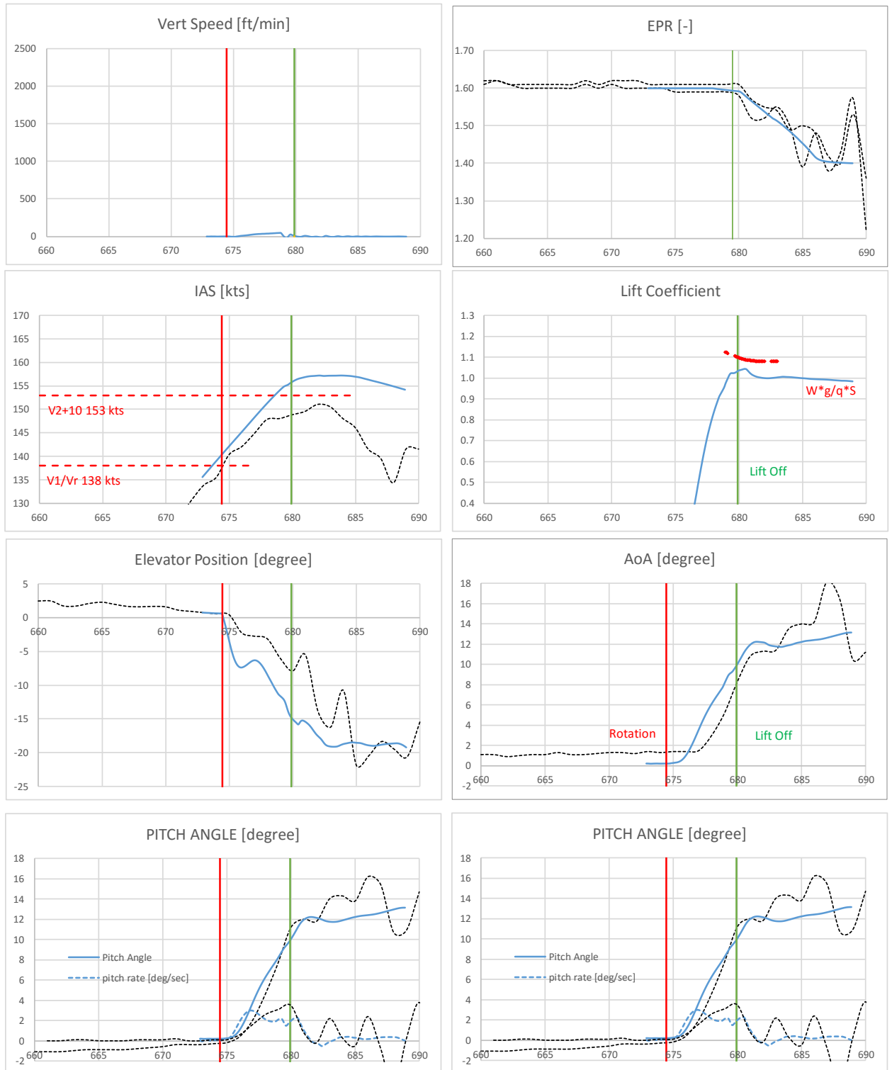
Рис. 22. Результаты моделирования с "загрязненным" крылом (параметры, обозначенные на графиках черными точками, построены по записям FDR во время АП)
