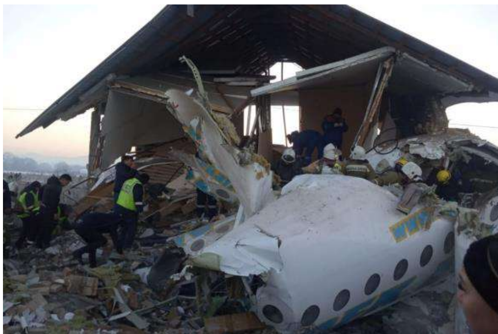
Рис. 13. Передняя часть фюзеляжа ВС Fokker-100
