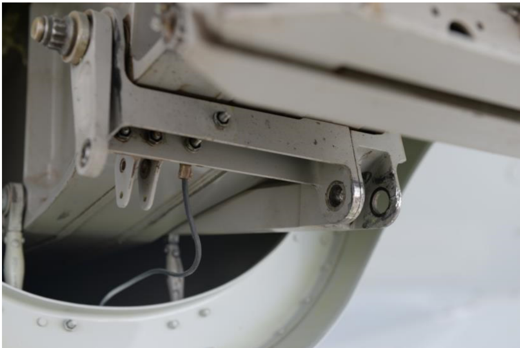
Abb. 4: Vordere Befestigungspunkte an der Klappenführungsschiene
