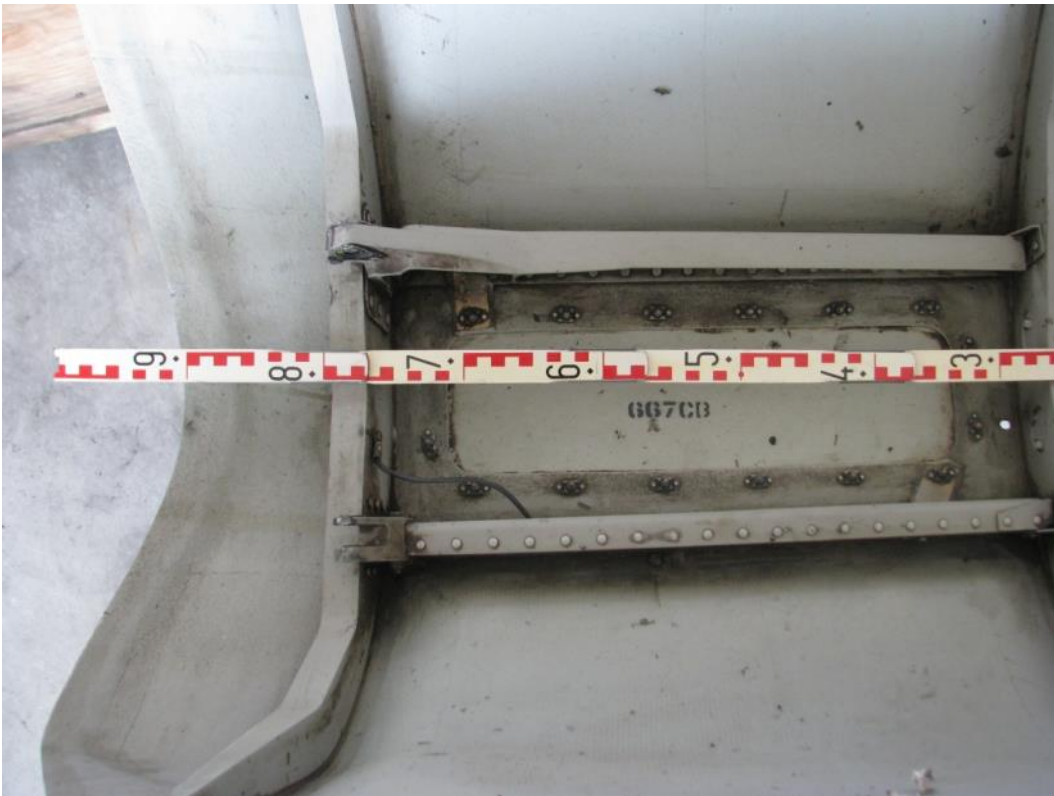
Abb. 5: Vordere Befestigungspunkte an der Verkleidung
