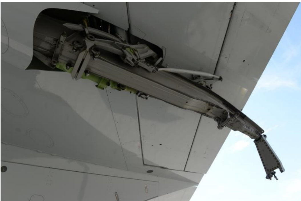
Abb. 2: Äußerer Landklappenantrieb- und schiene der rechten Tragfläche
