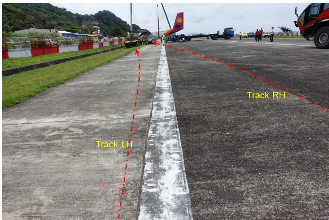
圖 1.12-2 事故機偏出 13 號跑道邊線後之左/右胎痕分布圖
