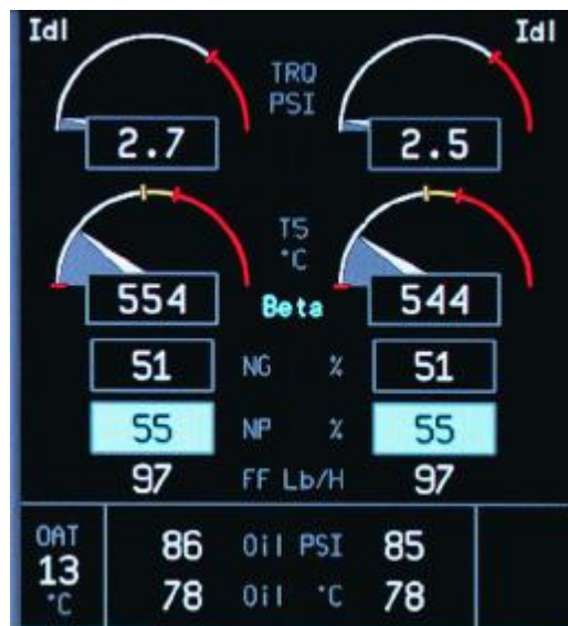
圖 1.6-2 發動機指示面板顯示藍色 Beta 指示
