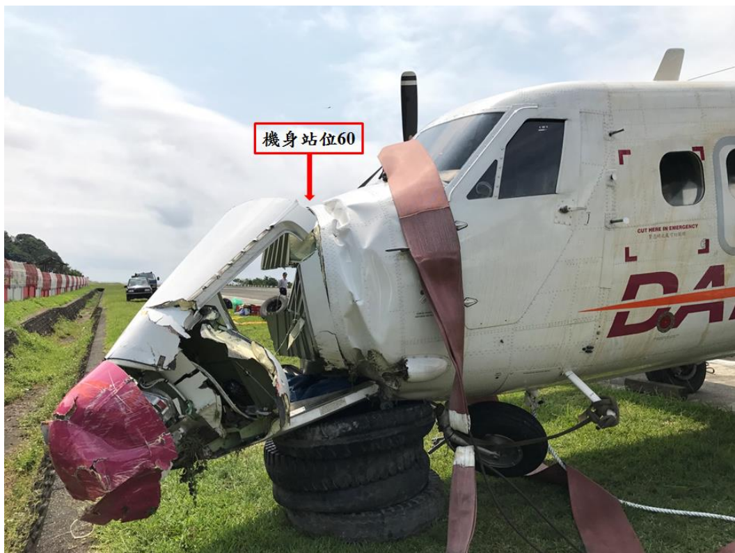
圖 1.12-5 機首部位結構損壞、鼻輪起落架支柱向後彎折
