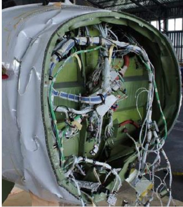
圖 1.12-6 機身站位 60 結構隔艙相接之結構及機身蒙皮變形
