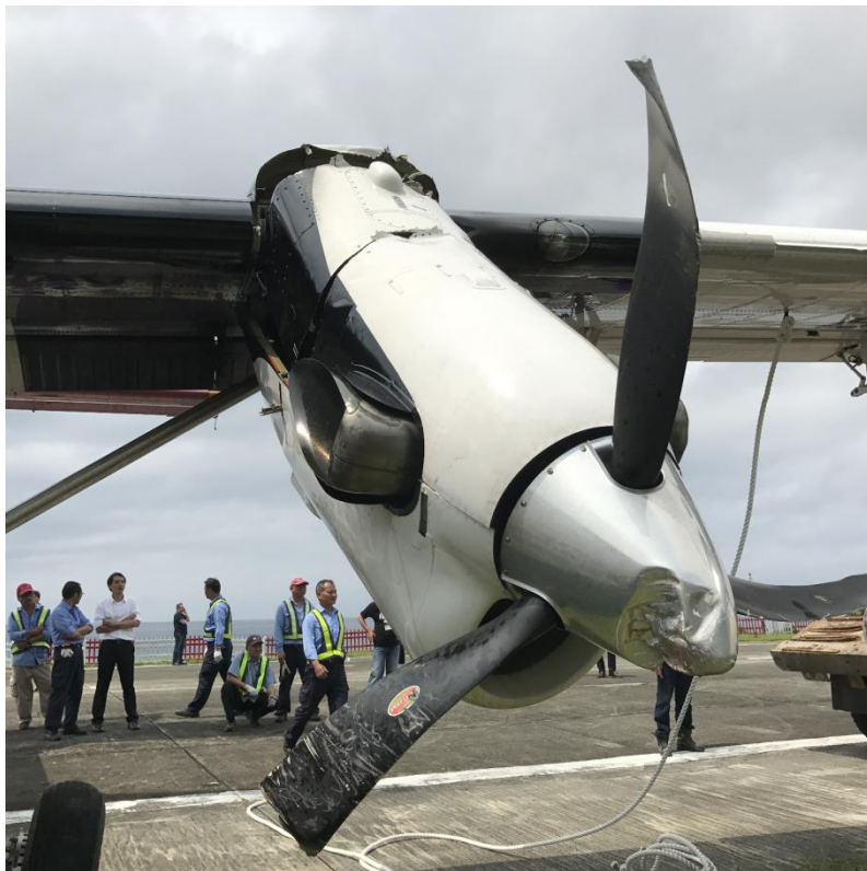
圖 1.12-7 左螺旋槳損壞
