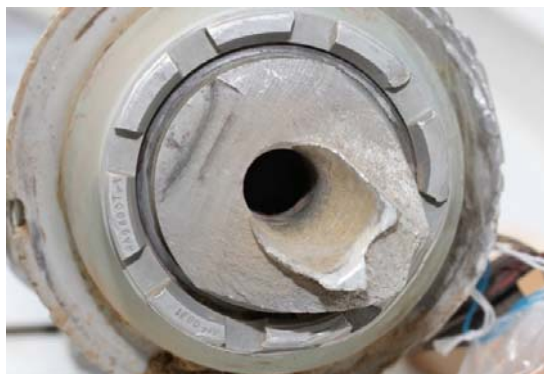
Figure 2: faciès de rupture de la vis du pied de la pale n° 2
