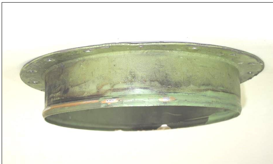
圖 1.16-3 內空調管進氣口外觀照片
