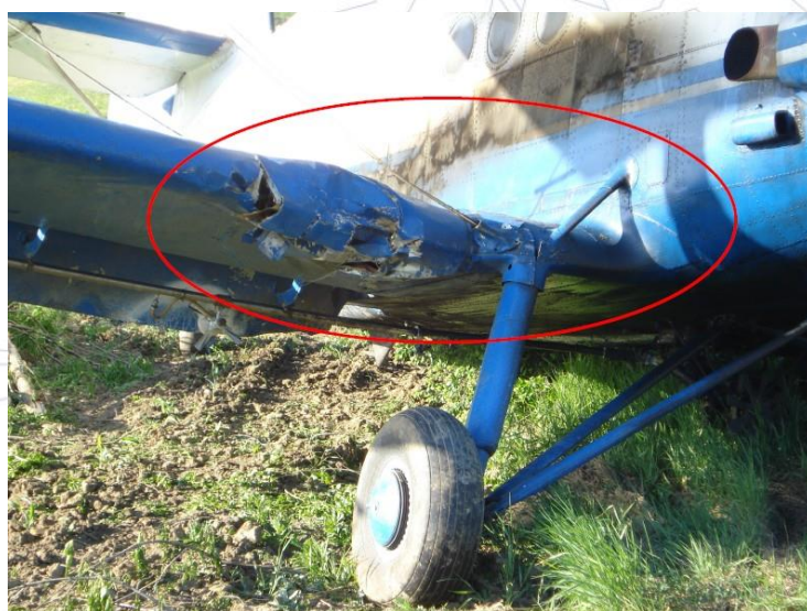
Fig. 6 – Avarii în zona aripii inferioare dreapta
