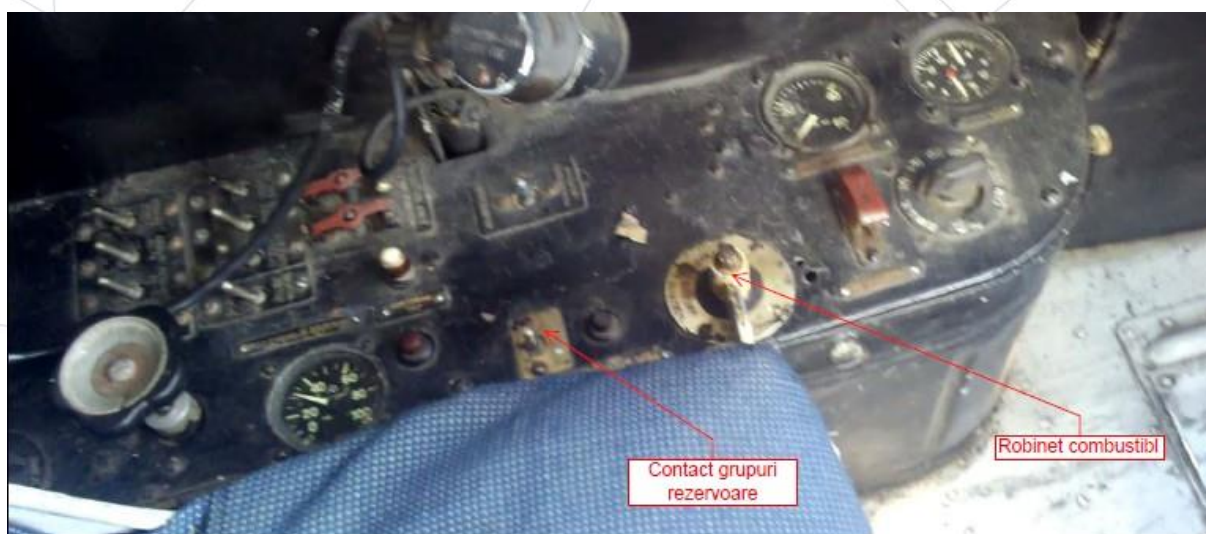
Fig. 8 - Poziție robinet și contact la momentul opririi motorului
