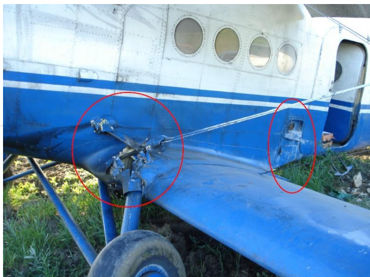
Fig. 5 – Avarii în zona aripii inferioare stânga
