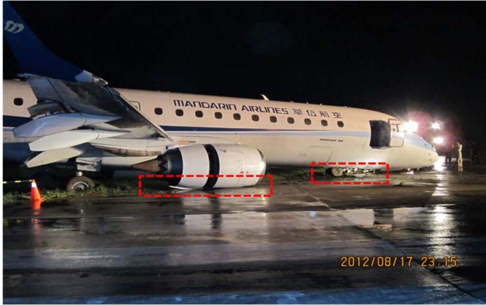
圖 1.12-4 鼻輪起落架斷折圖
