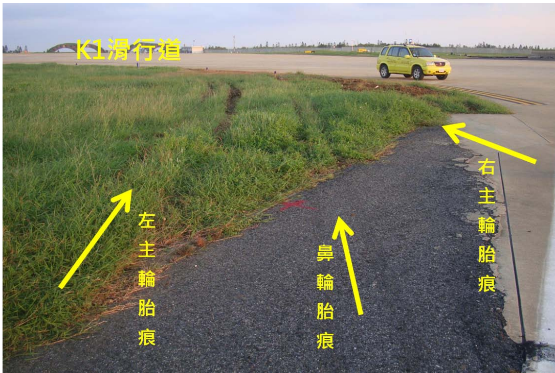
圖 1.12-1 航機落地滾行偏出跑道遺留胎痕圖
