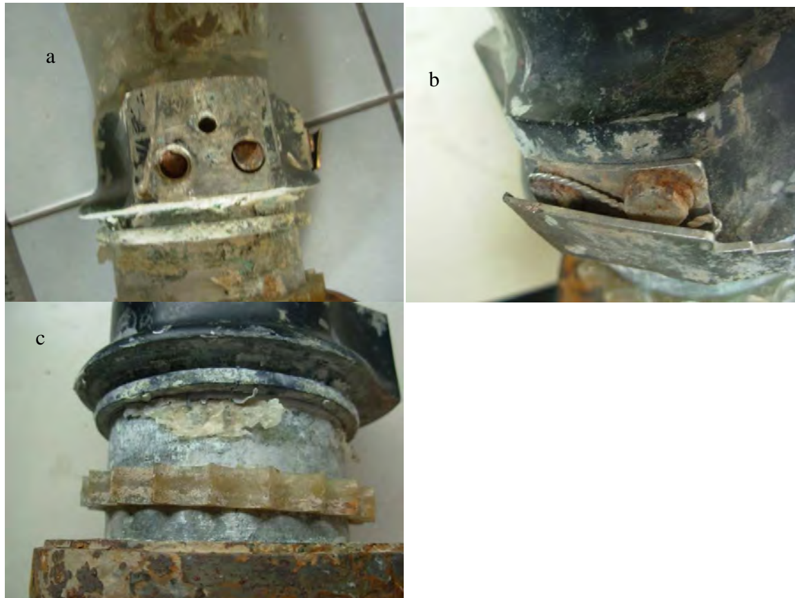
Figura 5: a) Detalle de los tornillos de sujeción fracturados, b) detalle de los tornillos de sujeción sanos, c) detalle del o-ring y alojamiento plástico.
