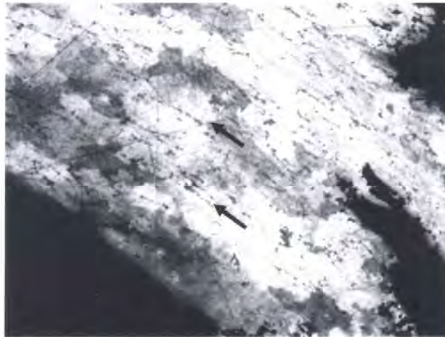
Figura 7 muestra correspondiente al leading edge atacada con reactivo de Keller 50x
