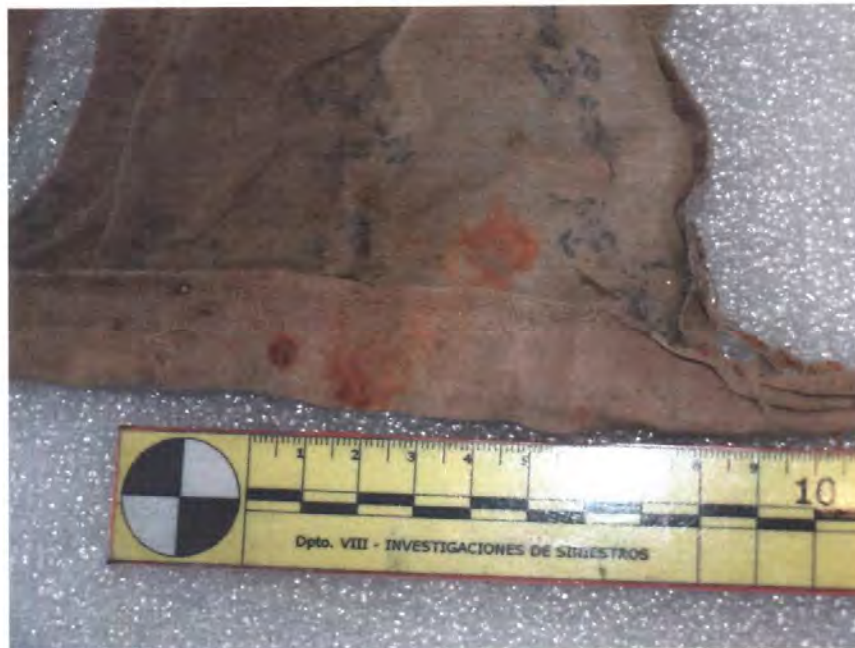
Documento Fotográfico N°4. Se observan manchas en la tela y sus dimensiones, pudiéndose determinar como en otras marcas dejadas por la oxidación de un metal en contacto con esta.
