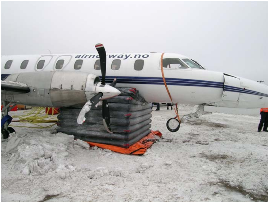
Figur 5: Bilde fra bergingsarbeidet som viser skader i nesepartiet.
