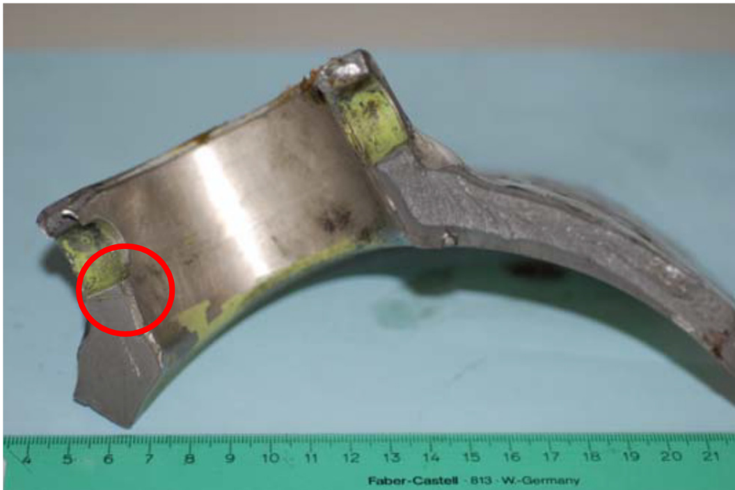
Abb. 4: Bruchstück mit Bruchausgangsbereich
