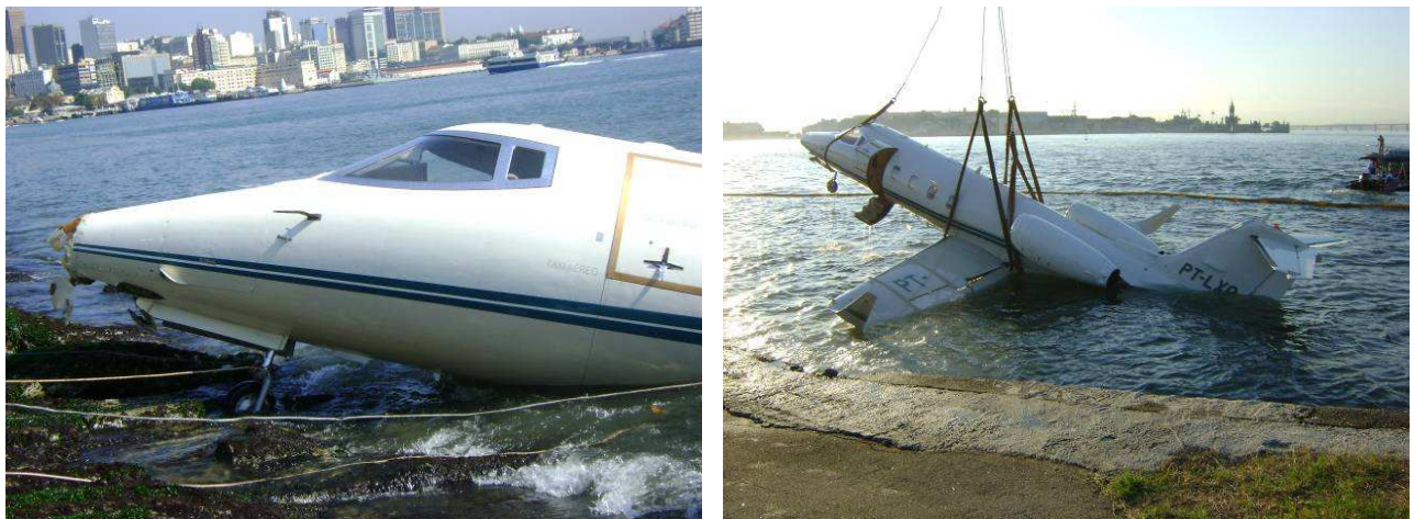
Figura 05: Danos no nariz da aeronave, em razão do impacto contra a água, e a retirada da aeronave da água, provocando danos nos flapes e no bordo de ataque da asa.
