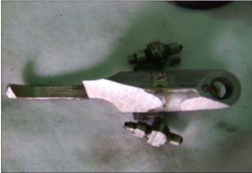
[사진 8] 손상된 드래그 브레이스 파단면
