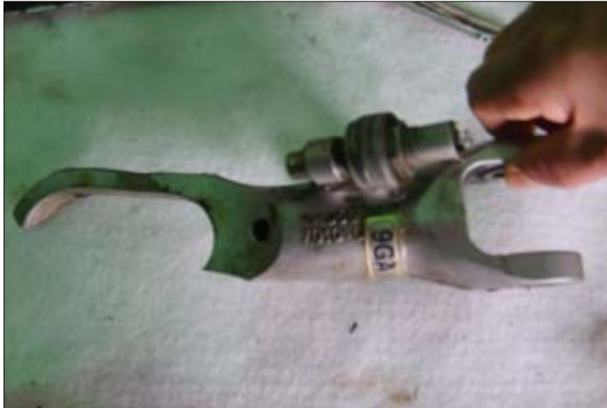
[사진 6] 외력에 의해 변형된 드래그 브레이스(Drag Brace)
