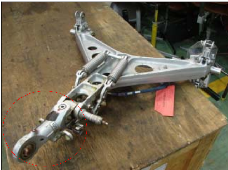
[사진 7] 정상 드래그 브레이스(Drag Brace)
