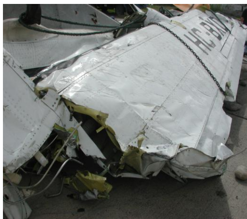
Tanque y cañerías de combustible
