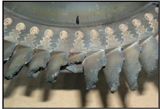
Turbina del compresor lado frontal ampliación
