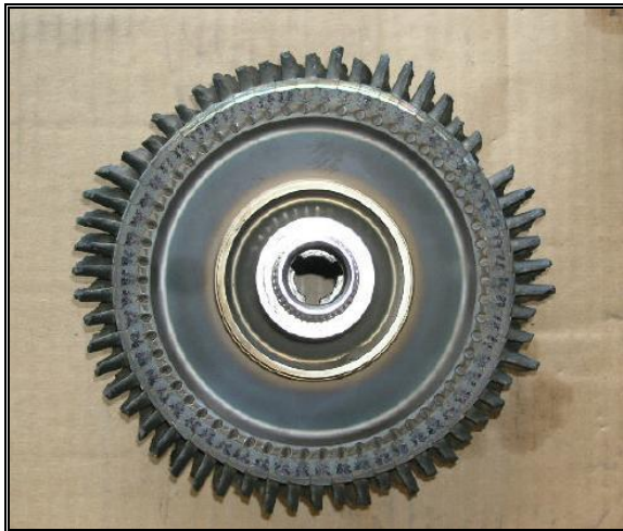
Turbina de compresor lado posterior
