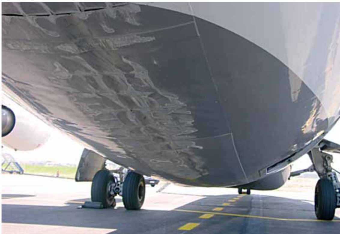
Danni alla fusoliera.
