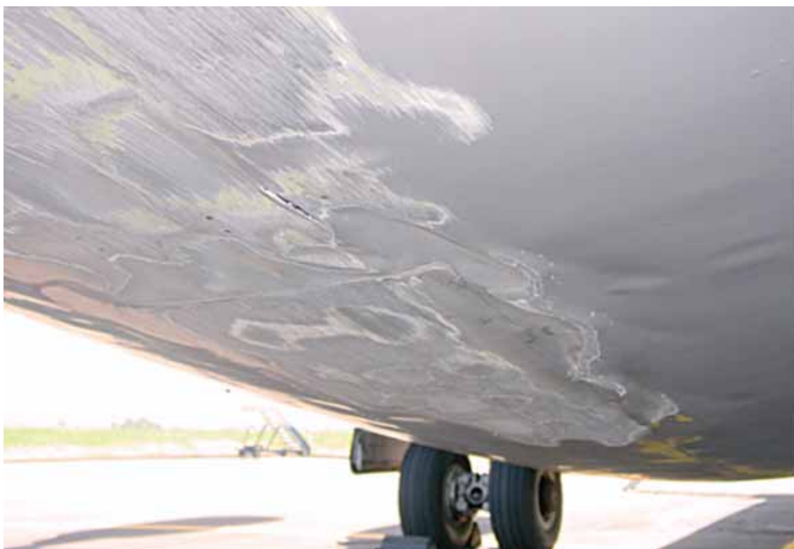
Particolari danni fusoliera nel punto di contatto con la pista.
