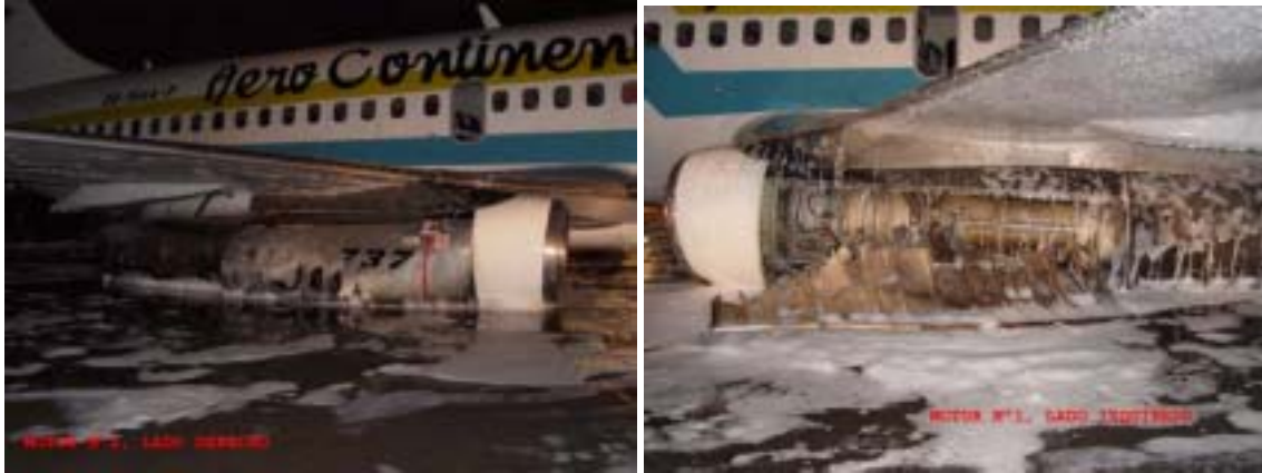
MOTORES N°2 Y N°1, ROCIADOS EN ESPUMA RETARDANTE.
