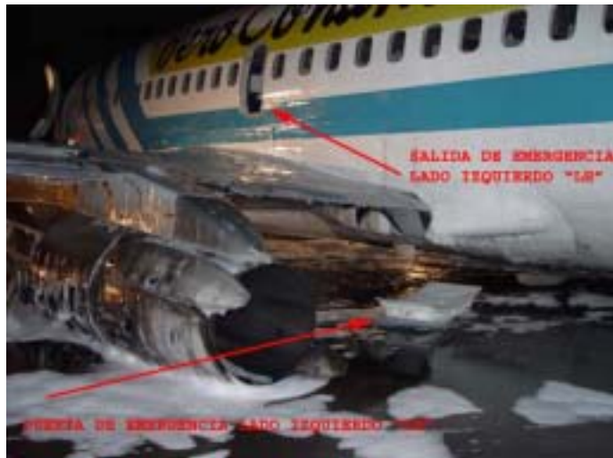
PUERTA DE EMERGENCIA DEL LADO IZQUIERDO (LH) EN EL SUELO LUEGO DE LA EVACUACIÓN.
