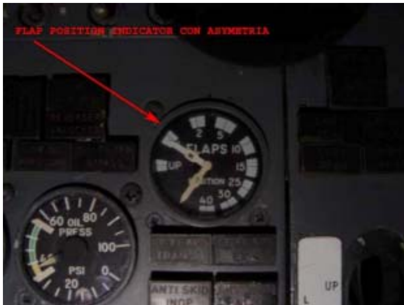
FOTO DEL FLAP POSITION INDICATOR COMO SE ENCONTRO DENTRO DE LA CABINA DE MANDO.
