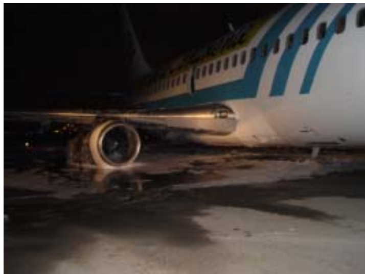
POSICIÓN FINAL DE LA AERONAVE OB-1544-P CON TRENES DE ATERRIZAJE RETRAÍDOS.
