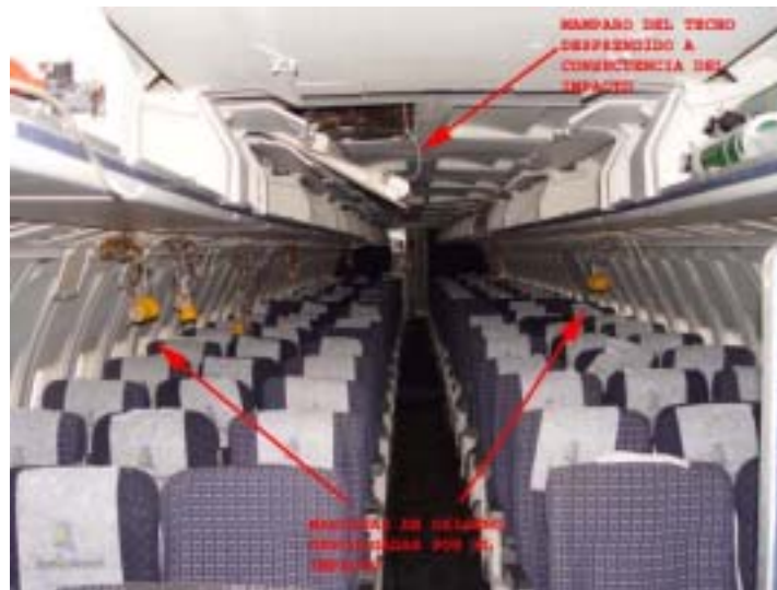
VISTA DE LA CABINA DE PASAJEROS Y DAÑOS OCASIONADOS POR EL ATERRIZAJE CON EL TREN RETRAIDO.
