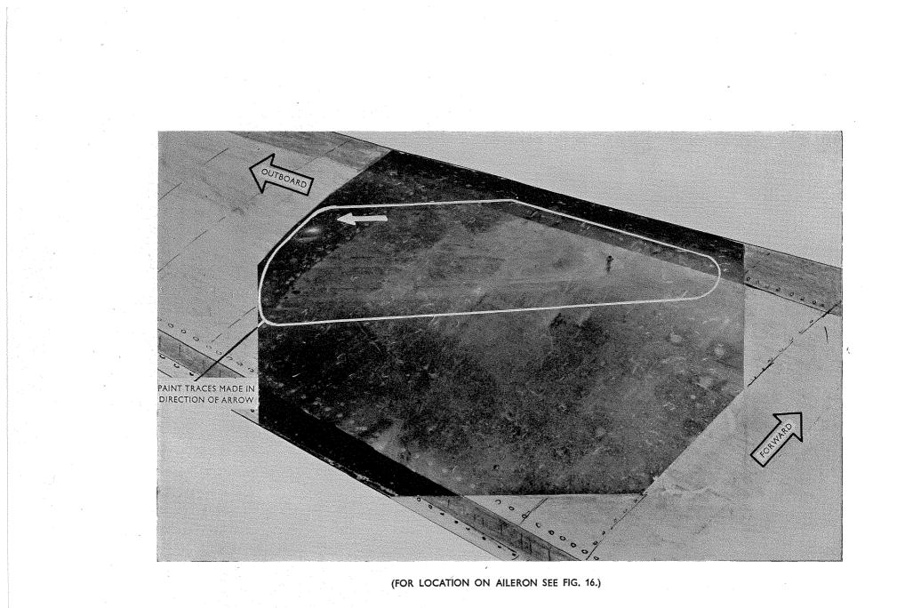
FIG. 13. PAINT TRACES OVER PORT AILERON UPPER SURFACE-G-ALYP.
